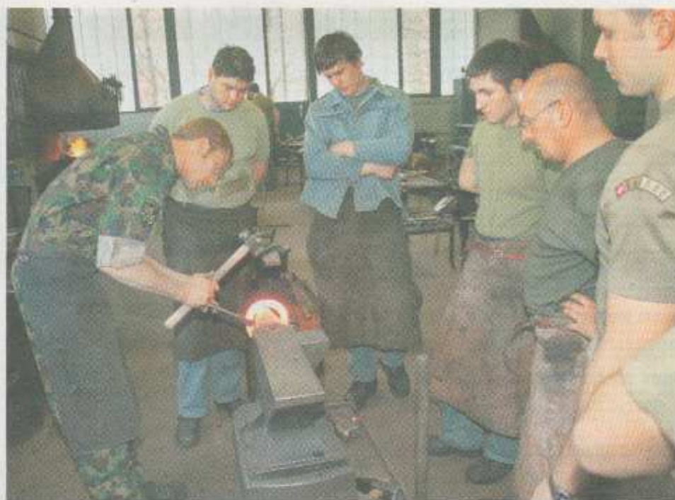
Die Armee bietet überbetriebliche Kurse für Hufschmied Lernende im dritten Lehrjahr an. Die neuen Eisen werden bearbeitet, bis sie auf die Hufe passen.
